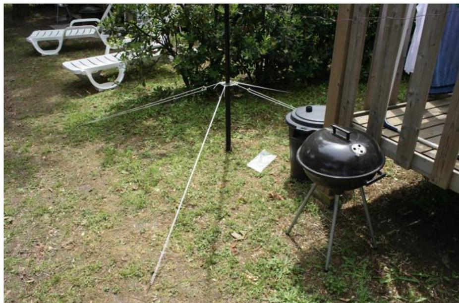
Abbildung 3: Sicherer Stand des Portabelmasts
